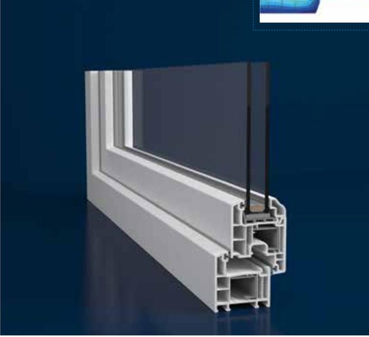
Everest Max Sistemi, 60 mm genişliğinde olup, 4 odacıklı ve 2 contalı olarak tasarlanmıştır. TPE conta kullanımı ile sisteme köşelerde kaynaklanabilme özelliği kazandırılmış, dolayısı ile güçlü sızdırmazlık sağlamıştır.
